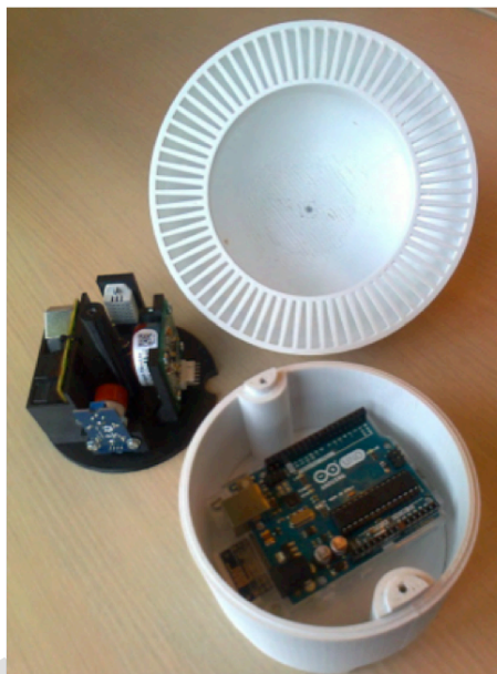
Figuur B3, Buiten- en binnenwerk van de paddestoel meetkit van het RIVM.
