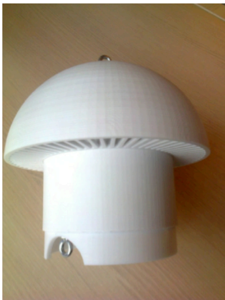
Figuur B3, Buiten- en binnenwerk van de paddestoel meetkit van het RIVM.
