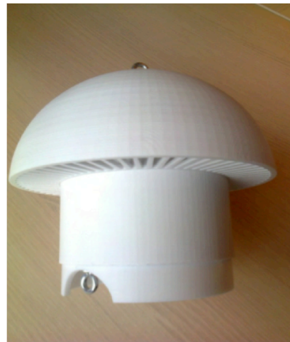
Figuur 3, Afbeelding van de Alphasense B43F sensor en van de paddestoelvormige behuizing, de meetkit van het RIVM.
